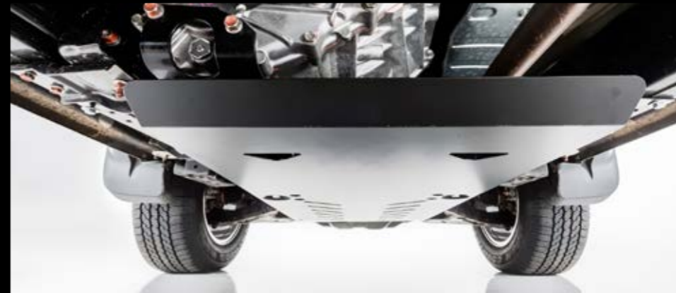
► Захист трансмісії СС / DC Товщина 2 мм. Номери деталей див. у довідковому переліку.
